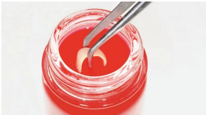
Abb. 14 und 15 Überprüfung der kompletten Versiegelung der Sinterfuge mittels Farbpenetrationstest.
