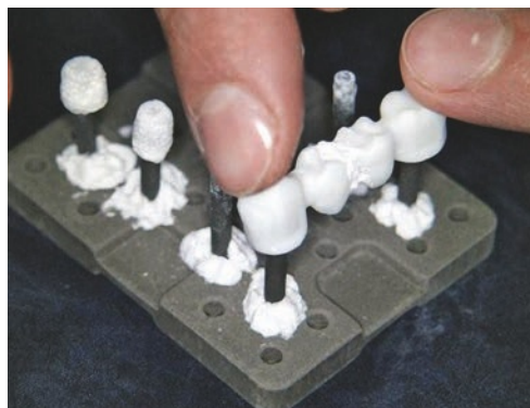
Abb. 7 Herstellung eines individuellen Brennträgers mit Brennwatte.
